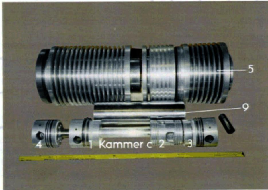
Die hier dargestellte Kolbenkonstellation spiegelt die Ausgangssituation des ersten Taktes wieder. Die Kammer c ist geöffnet und die Kammern b + a geschlossen. Das untere Bild zeigt die Situation nach Beendigung des ersten Taktes und vor Zündung beim zweiten Arbeitstakt.
